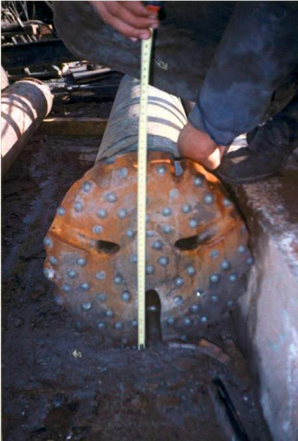
Detalhe Martelo de fundo com Bit 355 mm.
