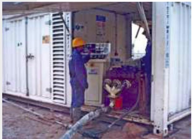
Bomba de Alta Pressão para Jet Grouting.
