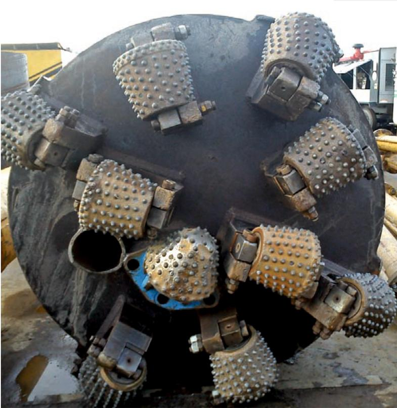
Detalhe da broca de perfuração Ø 2,00m com roller bit.
