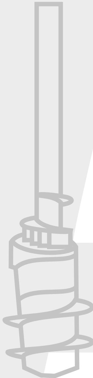
**A** Estaca Ômega é uma estaca de concreto moldada "in loco", com ausência total de vibração ou distúrbios durante a execução e sem a retirada do solo da escavação comportando-se como uma estaca de deslocamento.
