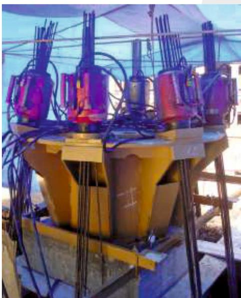
Estrutura de reação para prova de carga até 1200tf.
